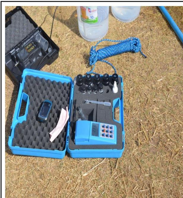
Equipos: Multiparámetro, turbidímetro y GPS
